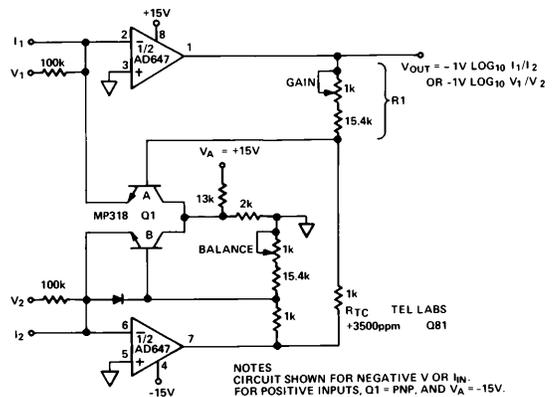
Figure 25. Log-Ratio Amplifier
