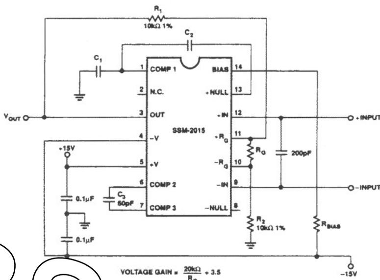
VOLTAGE GAIN =  $\frac{20k\Omega}{R_G} + 3.5$
